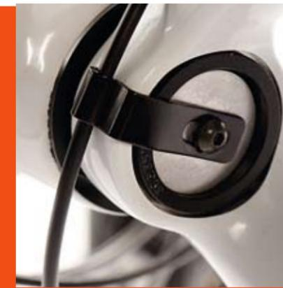
**SCHÖN GELÖST** Die Zugführung ist von unten in den Gabelschaft geklemmt. Das Kabel kann nicht scheuern.
