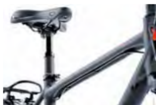
Gute Lösung: Das Bremskabel verläuft unsichtbar unter dem Oberrohr.
