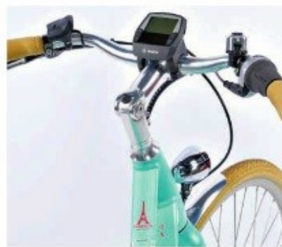
Das Cockpit mit dem verstellbaren Vorbau. Am Oberrohr sichtbar: der Eiffelturm.
