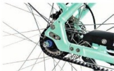
Der Gates Riemenantrieb macht eine Rahmenöffnung notwendig.
