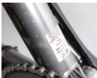
Vorbildlich aufgeräumt: Aufkleber mit Information zur Gewichtszulassung und versteckte Züge.
