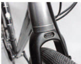
Doppelt hält besser: Zwei Bohrungen statt einer großen schwächen die Carbongabelbrücke weniger.
